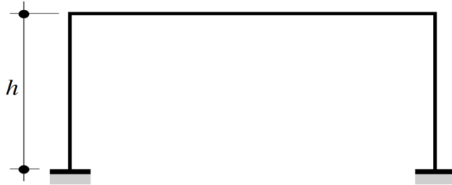
Fig. 11.26b: valeurs limites, bornes, des longueurs de flambage cadres non-tenus latéralement
